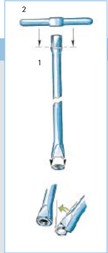
Fig. 35b: Chave de porca FW320R (1) com cabo FW312R (2)
