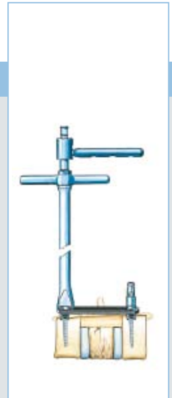
Fig. 37b: Aperto da porca, aplicando o torque de contrabalanceamento
