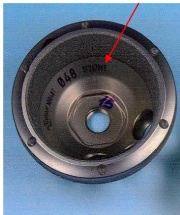
Figura: Marcação a laser no acetábulo não cimentado
